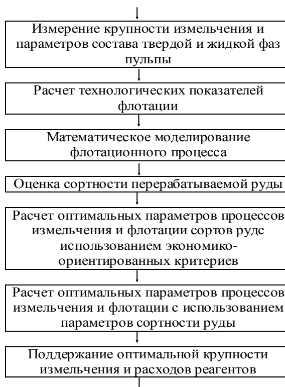
Рис. 1. Общий алгоритм управления процессом флотации с использованием процедуры оценки сортности руд и экономико-ориентированных критериев эффективности
