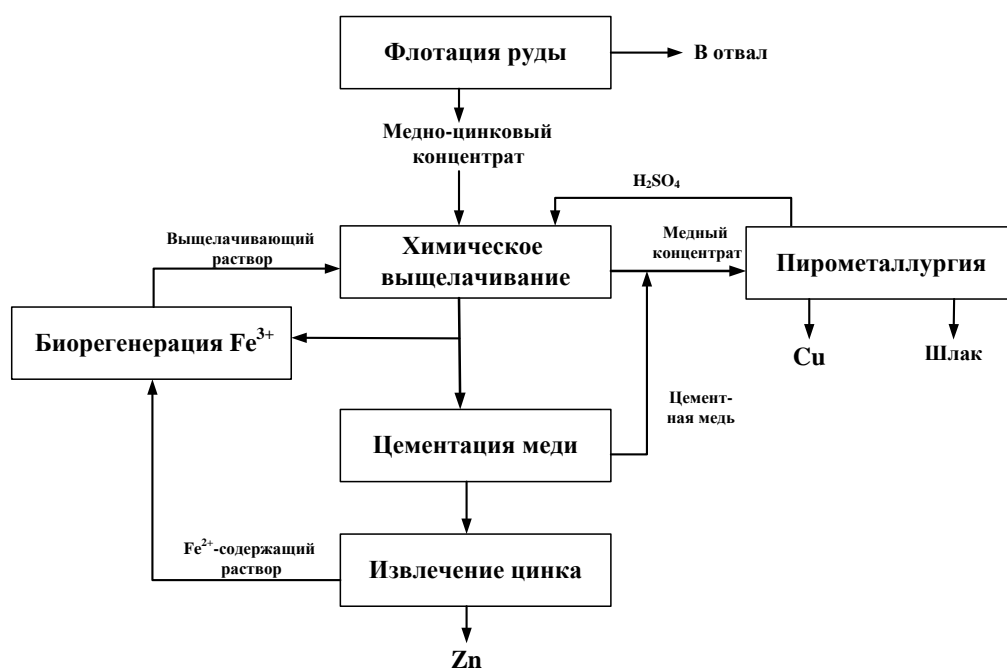
Рис. 2. Схема переработки медно-цинковых сульфидных концентратов с применением двухстадийной биогидрометаллургической технологии
