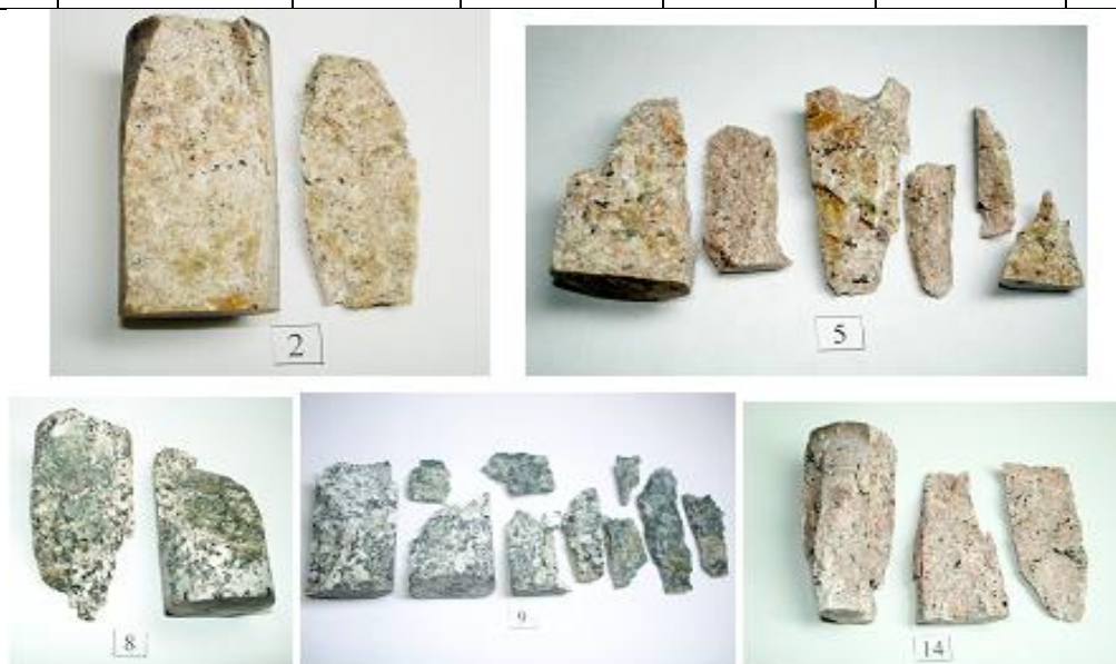
Рисунок. Фотографии образцов керна гранита после разрушения: 2 – исходного образца; 5, 8, 9 и 14 – образцов керна, обработанных потоком ускоренных электронов при дозах 5, 10, 15 и 20 кГр
