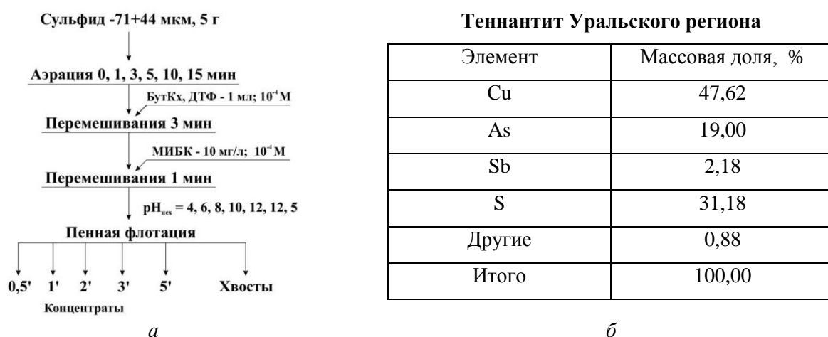
Рис. 1. Принципиальная схема проведения флотационных опытов (а) и элементный состав мономинеральной фракции теннантита (б)
