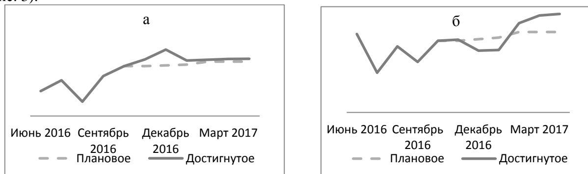
Рис. 2. Плановое и достигнутое содержание меди в медном концентрате (а) и никеля в никель-пирротинном концентрате (б)
