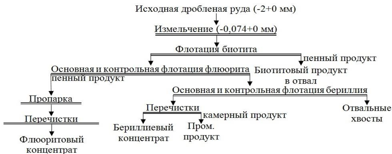
Рисунок. Уточненная принципиальная технологическая схема флотации флюорит-бериллиевой руды
