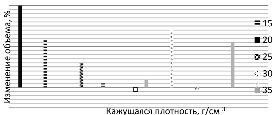
Рис. 3. Зависимость показателя изменения объема образца после термообработки от кажущейся плотности и фракционного состава кианитовой руды в шихте (в легенде количество кианитовой руды фракции менее 0,063 мм в шихте)
