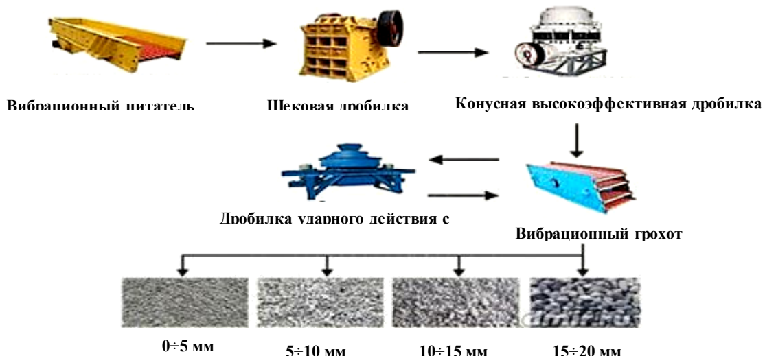
Рис. 3. Технологический процесс по дроблению базальтов для строительства автомагистрали посредством кооперации стройиндустрии с горнодобывающими и горно-перерабатывающими предприятиями, горно-химическими комбинатами
