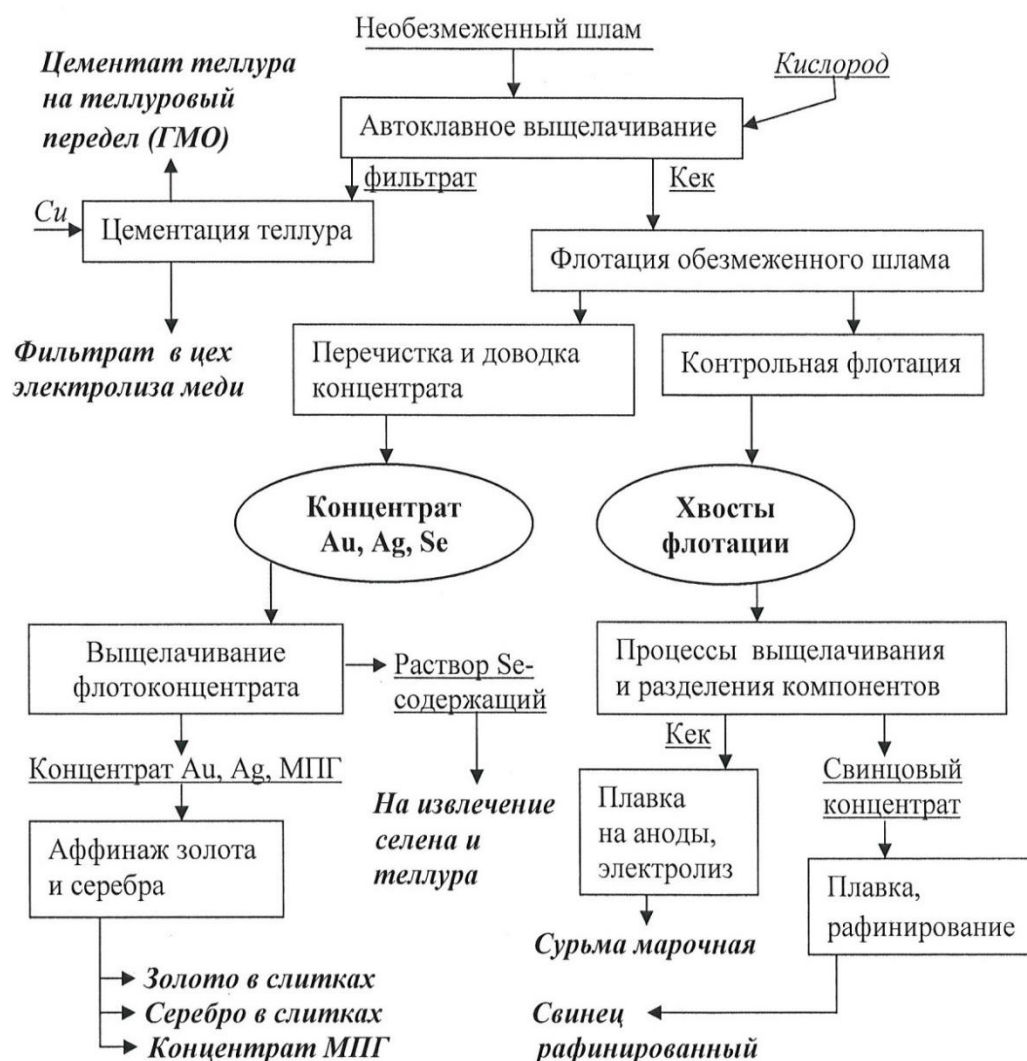
Рисунок. Технологическая схема гидрометаллургической переработки медьэлектролитных шламов
