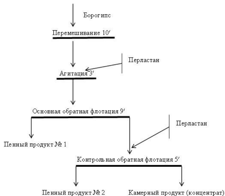
Рис. 2. Схема обратной флотации борогипса с использованием перластана
